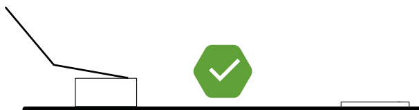
Рисунок 3. Корректное сгибание рычага тампера
